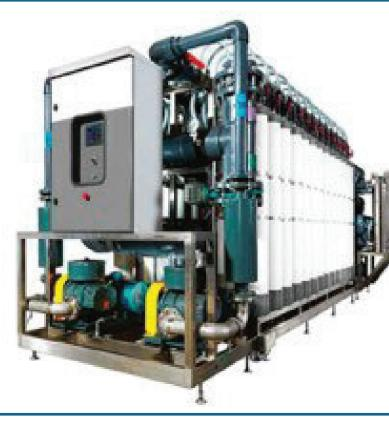
Ultrafiltração é uma barreira física que tem por objetivo remover os sólidos suspensos coloides e vírus presentes na água. A filtração ocorre através da passagem da água pelas membranas de ultrafiltração que permite que as moléculas de água, sais, cor, etc., permeiem através das mesmas, retendo as impurezas presentes na água de alimentação.
