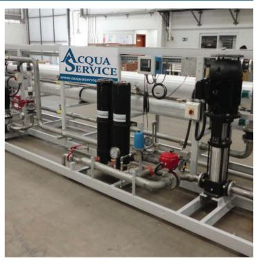
Diferentemente da Osmose Natura, o processo de Osmose Reversa utiliza uma fonte de pressão externa para fazer com que a água, através de uma membrana semipermeável, vá da solução mais concentrada para a solução mais diluída. A membrana de Osmose Reversa permite que a água passe enquanto retém uma grande porcentagem de inorgânicos dissolvidos.
