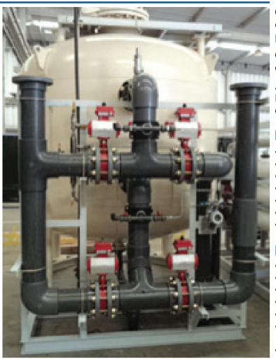
Os sistemas de filtração tem a função de remover materiais sólidos e impurezas suspensas do fluído através da passagem do mesmo por uma diversidade de meios filtrantes.
